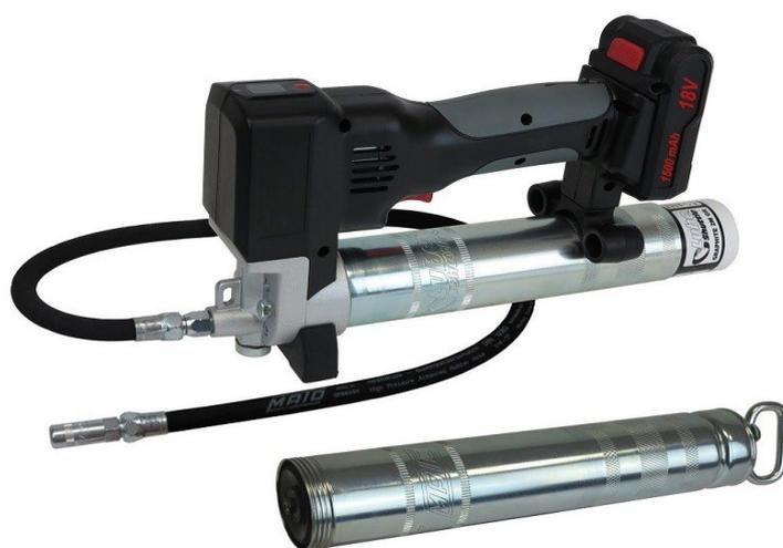
Electrique 18 V Lilon 2-en-1 se recharge en utilisant à la fois la technologie Lube-Shuttle® pour un chargement/déchargement rapide et propre sans ouvrir la pompe, mais aussi avec des cartouches de graisse en vrac !
